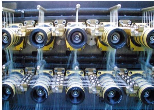
*Heute werden im LEONI-Werk Kötzing auf einer modernen Mehrdraht-Ziehmaschine in einem Arbeitsgang 24 Drähte gleichzeitig gezogen.*
