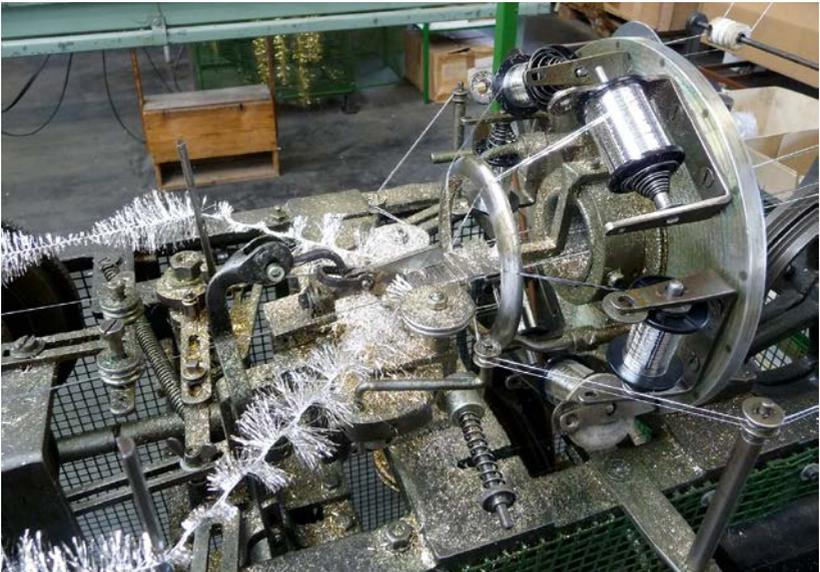
*Lamettagirlanden-Maschine mit Schneidvorrichtung (Bildmitte) und rotierendem Ablaufkopf mit den Plättspulen (Foto: Riffelmacher & Weinberger)*
